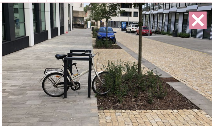
05 Nevhodné umiestnenie stojanov mimo koridoru PMZ. Nedostatočný manipulačný priestor okolo cyklostojanov. Bratislava, Žižkova ulica
