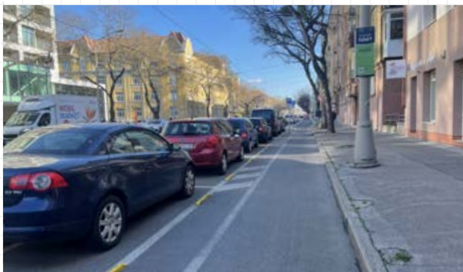
14 Príklad vyhradeného cyklistického pruhu oddeleného od parkovania bezpečnostným priestorom a tzv. carstopmi. Vajnorská, Bratislava
