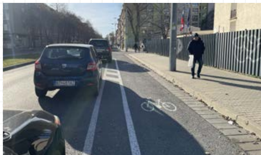
05 Vhodný príklad vyhradeného cyklistického pruhu vedeného paralelne s pozdĺžnym parkovaním s aplikáciou bezpečnostného odstupu formou vodorovného značenia. Bratislava, Košická
