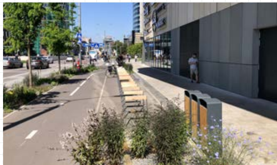
04 Vhodný príklad segregovanej obojsmernej cyklistickej komunikácie oddelenej od chodcov i hlavného dopravného priestoru zeleným deliacim pásmom. Bratislava, Mlynské Nivy
