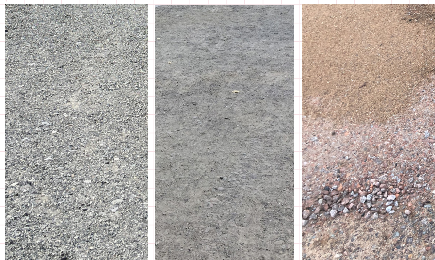
Zľava: drvené kamenivo, jemné drvené kamenivo, kamenivo rôznych frakcií (vrstvy mlatového povrchu).
