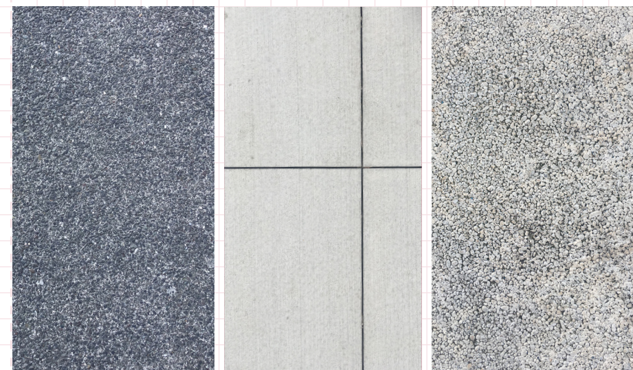
Zľava: asfaltobetón, betónový povrch, priepustný betón.
