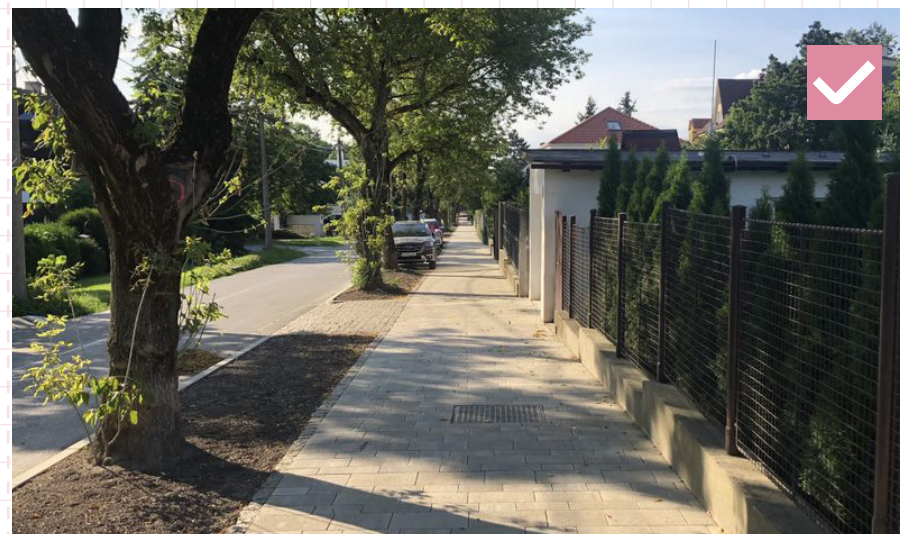
66 Zachovaná vizuálna aj úrovňová kontinuita chodníka neprerušovaná odlišným povrchom v mieste prejazdu do garáže. Bratislava, Prokopa Veľkého
