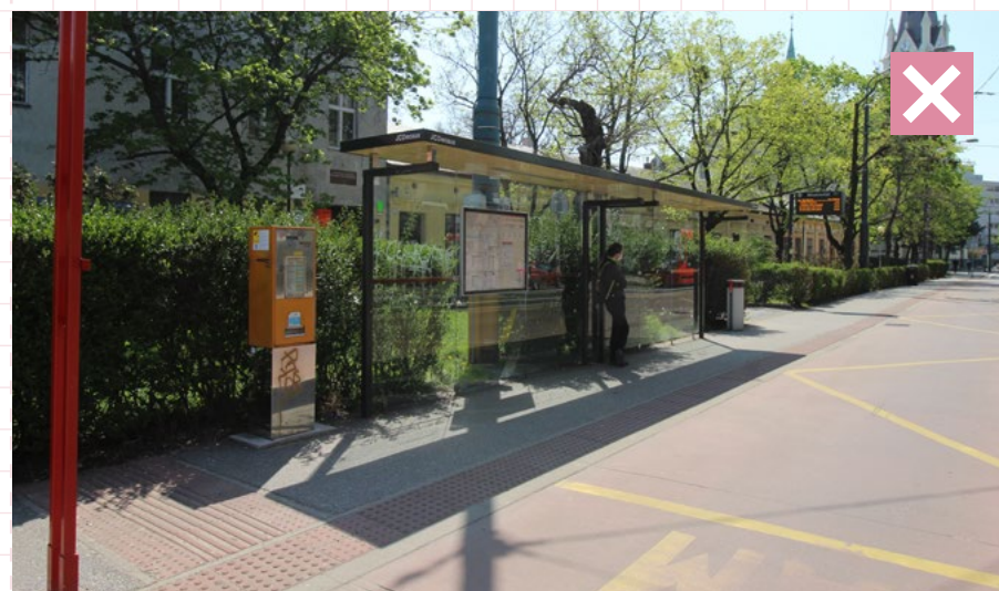
37 Príklad umiestnenia prístrešku v tesnej blízkosti kríkov. Toto umiestnenie nezachováva dostatočný priestor na údržbu zelene a tiež prístrešku. Bratislava, zastávka Blumentál
