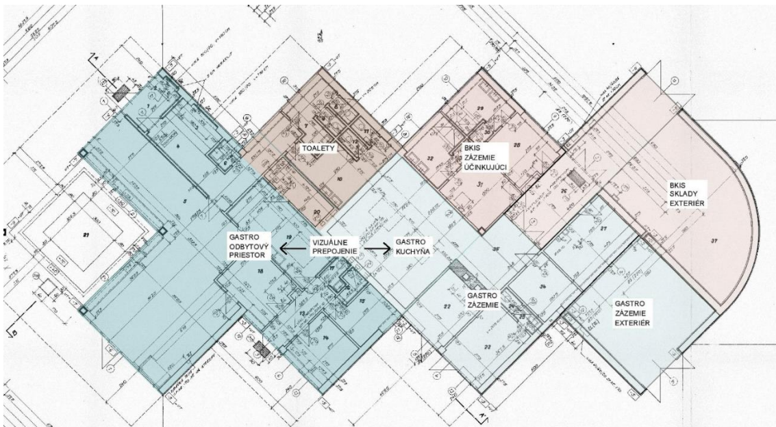
Funkčno-prevádzková schéma vyznačená na pôdoryse z roku 1975 (obr. Príloha č.1)
